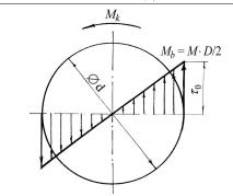
Рис. 2 - Распределение напряжений в поперечном сечении пружины при кручении (для пружин d/D <= 1/6)
