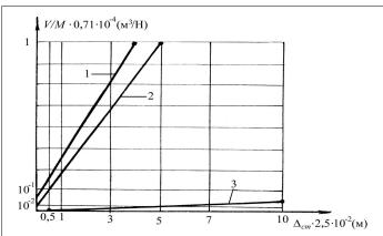
1 – резина при сжатии; 2 – резина при сдвиге; 3 – сталь при сдвиге
